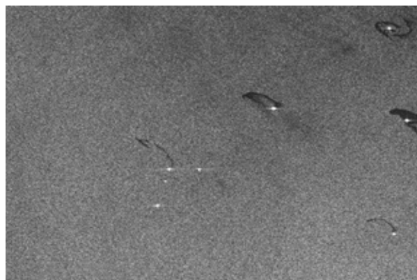
I punti luminosi nell'immagine sono piattaforme petrolifere al largo della costa norvegese. Le aree nere mostrano gli scarichi d'acqua delle piattaforme in mare aperto. L'acqua è leggermente oleosa, anche se non abbastanza da violare le norme. Il radar con cui è equipaggiato Sentinel-1 ha la sensibilità necessaria per identificare questi eventi (Crediti: Agenzia Spaziale Europea - ESA).
